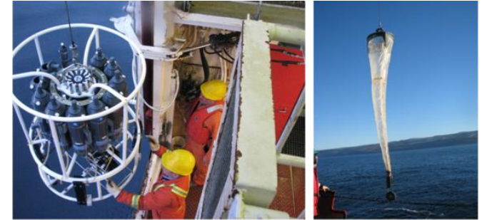
Figure 1 : Échantillonnage d'eau à l'aide d'une rosette et de zooplancton à l'aide d'un filet vertical.
